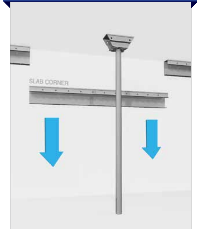
4. Pembongkaran sudut slab
