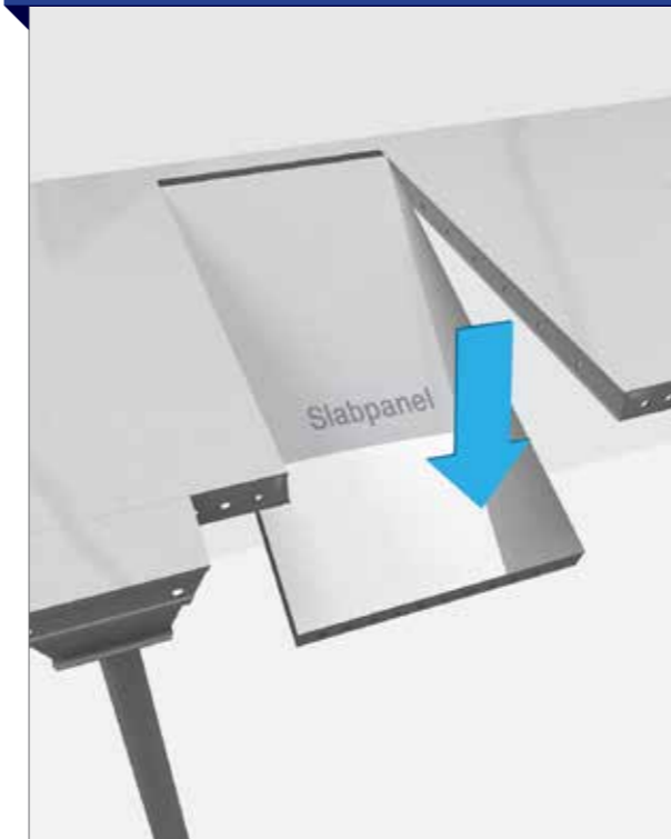
3. Pembongkaran panel slab
